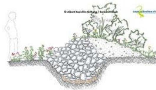
Abbildung 7: Musterschema für die Anlage von Steinriegeln mit Eidechsen - Winterquartier
